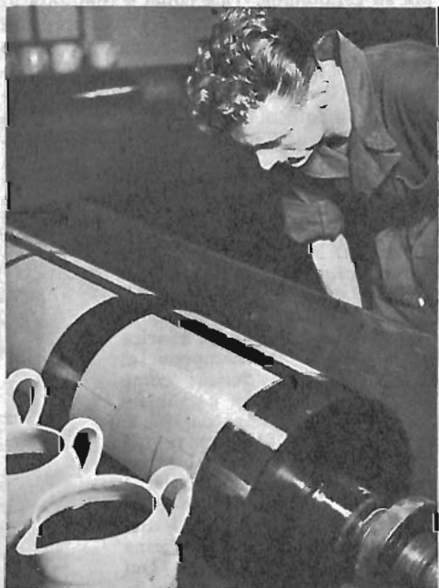
L'operazione più delicata: l'incisione sul cilindro; si vedono le brocche che contengono gli acidi di varia gradazione.
